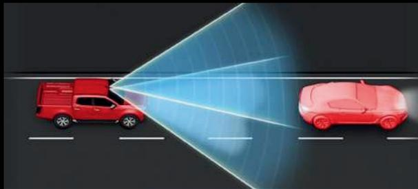
**AHB (Automatic High Beam).** Il sistema ADAS AHB regola automaticamente i fari abbaglianti del veicolo, passando agli anabbaglianti quando rileva veicoli in avvicinamento o in condizioni di illuminazione urbana. Questo permette una visibilità ottimale senza abbagliare gli altri conducenti, migliorando la sicurezza e il comfort di guida notturna.
