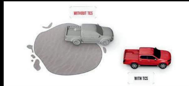
**TCS (Traction Control System).** Il sistema TCS monitora costantemente la trazione delle ruote e regola automaticamente la potenza del motore e/o applica i freni per prevenire la perdita di aderenza delle ruote durante l'accelerazione, migliorando così la stabilità e la trazione del veicolo su superfici scivolose o a bassa aderenza.
