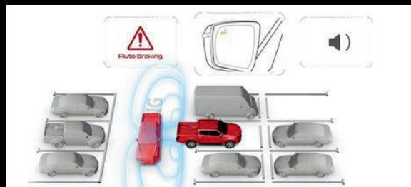
**RCTA (Rear Cross Traffic Alert) + RCTB (Rear Cross Traffic Brake).** Il sistema RCTA avvisa il conducente di veicoli in avvicinamento laterale durante le manovre in retromarcia, prevenendo collisioni.
