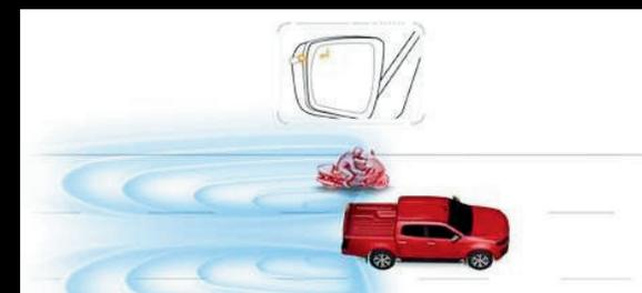
**BSM (Blind Spot Monitoring).** Il sistema BSM monitora gli angoli ciechi e avvisa il conducente della presenza di veicoli non visibili negli specchietti laterali.
