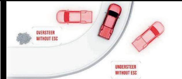
**ESC (Electronic Stability Control).** Il sistema ESC monitora costantemente la stabilità del veicolo e interviene automaticamente frenando singole ruote o riducendo la potenza del motore per prevenire il sottosterzo o il sovrasterzo, contribuendo a mantenere il controllo del veicolo in situazioni di emergenza o su strade scivolose.
