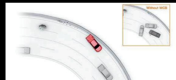
**MCB (Multi-Collision Brake).** Il sistema MCB applica automaticamente i freni dopo una collisione iniziale, riducendo la possibilità di impatti secondari e migliorando la sicurezza complessiva del veicolo.
