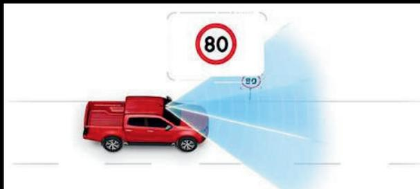
**TSR (Traffic Sign Recognition).** Il sistema TSR rileva e visualizza i segnali stradali sul display del cruscotto, mantenendo il conducente informato delle limitazioni e regolazioni stradali.
