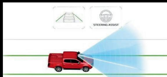
**LKAS (Lane Keeping Assist System).** Il sistema LKAS aiuta a mantenere il veicolo centrato nella corsia, applicando correzioni leggere al volante.
